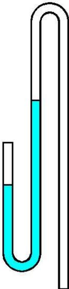
Anhebung der Wassersäule durch den Druck in der Saugglocke
