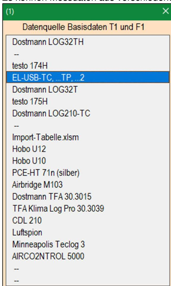
Von [www.luftdicht.de](http://www.luftdicht.de) werden der Datenlogger „Dostmann LOG 32 TH“ für die Aufzeichnung von Temperatur und Feuchte angeboten. Dieser Datenlogger LOG 32 TH hat den Vorteil, dass der Import der Messdaten direkt von der Excelmappe aus möglich ist. Er wird vom PC wie ein USB-Speicherstift erkannt. Es gibt keine Treiberkonflikte bei unterschiedlichen Windows-Versionen.
