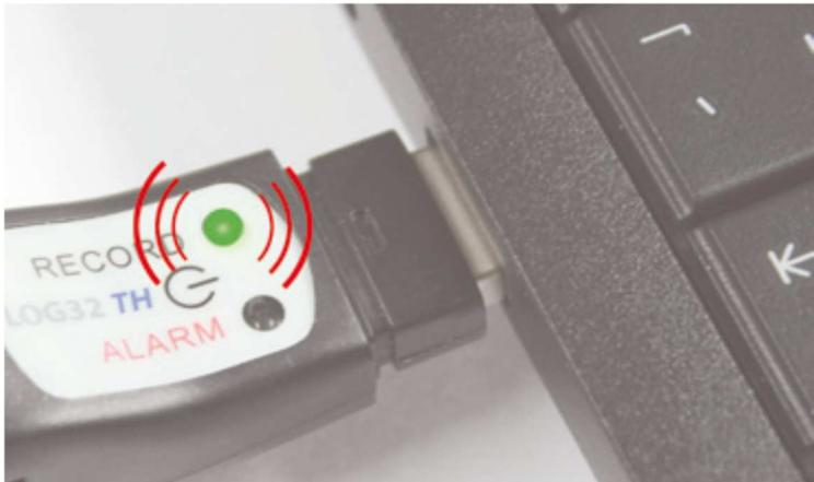
Logger mit USB Schnittstelle verbinden.
