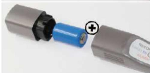
Leere Batterie entnehmen und neue Batterie wie abgebildet einlegen.
