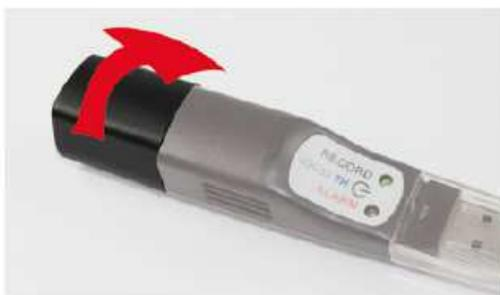
Kappe leicht drehen (ca. 10°) das Batteriefach öffnet sich.
