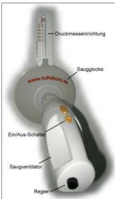
Mit diesem Gerät kann man undichte Elektroinbaudosen finden, ohne Druckaufbau im gesamten Gebäude.
