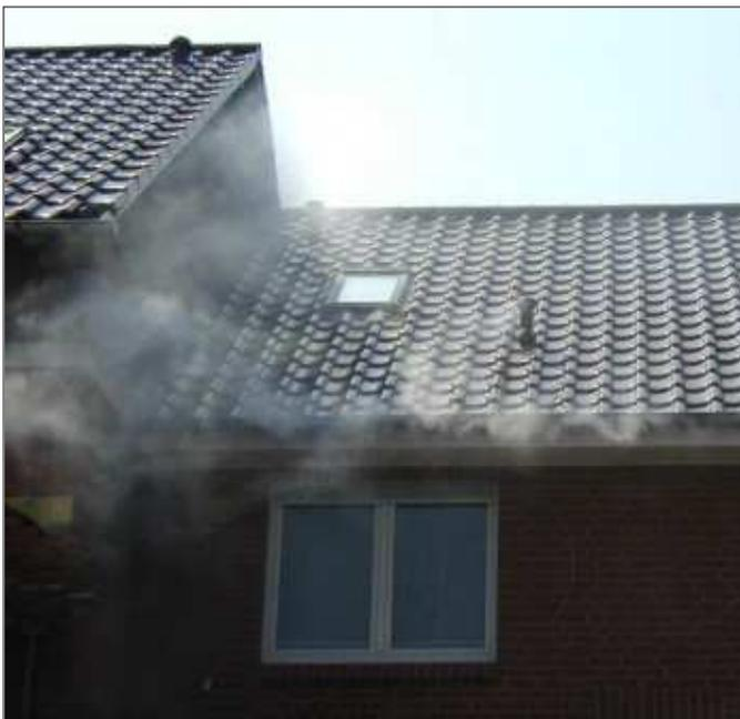
Das Bad im Dachgeschoss wurde mit Nebel gefüllt und es wurde ein Überdruck von 50 Pa erzeugt.
