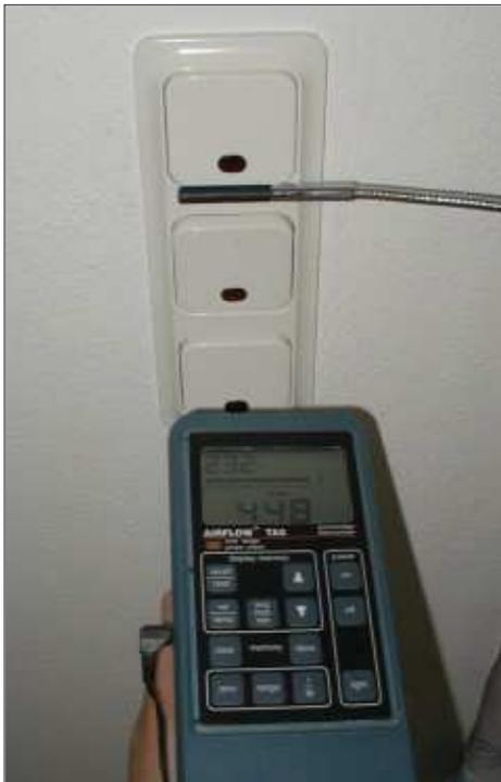
Luftgeschwindigkeit 4,48 m/s bei 50 Pa Druckdifferenz
